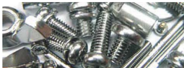
図2 表面に電極跡がなく、均一な仕上がり の三価クロムめっき
