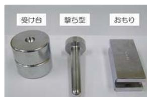
ち型と受け台の間に試験片を挟み、一定の高さからおもりを落下させて、衝撃変形による塗膜の割れ・はがれの有無で判定します。また、塗膜の割れ・はがれが認められない最も高いおもりの高さとしても評価します。
