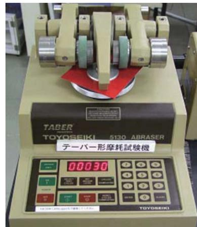
図5 耐摩耗試験 (テーバー式)
