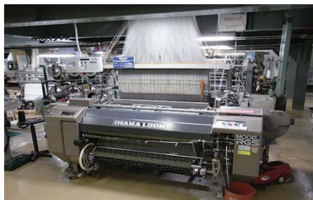
図6 ジャカード装置付き片側レピア織機
