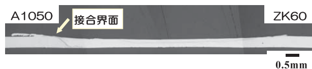
図6 厚さ0.4mmのA1050アルミニウムとZK60マグネシウム合金の摩擦攪拌接合部断面
