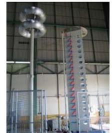
図5 雷インパルス電圧発生装置(イメージ)
