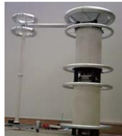
図4 交流高電圧発生装置(イメージ)
