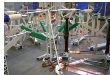
図6 雷インパルス電流発生装置(イメージ)
