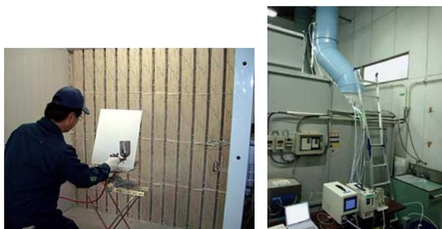
図1 塗装ブースシミュレータ
