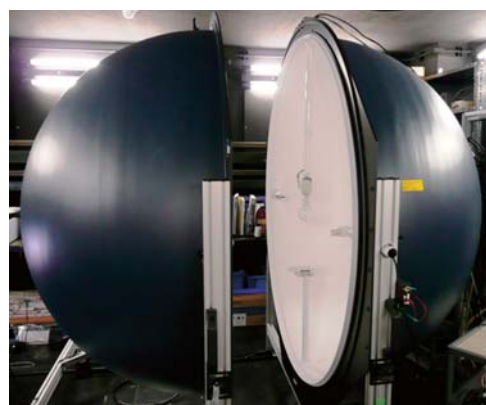
図4 LED用球形光束計（平成21年度導入）
