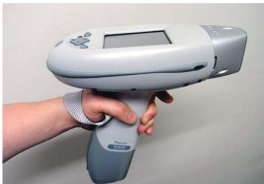
図1 携帯型蛍光X線分析装置外観
