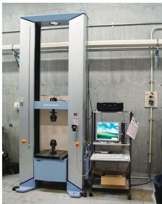
図1 20kN精密万能試験機
