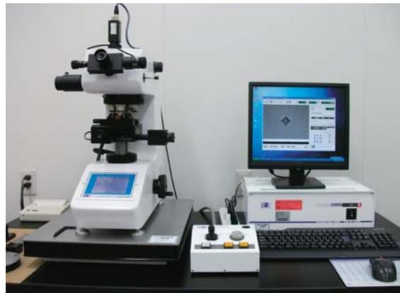
図1 マイクロビッカース硬さ試験機
