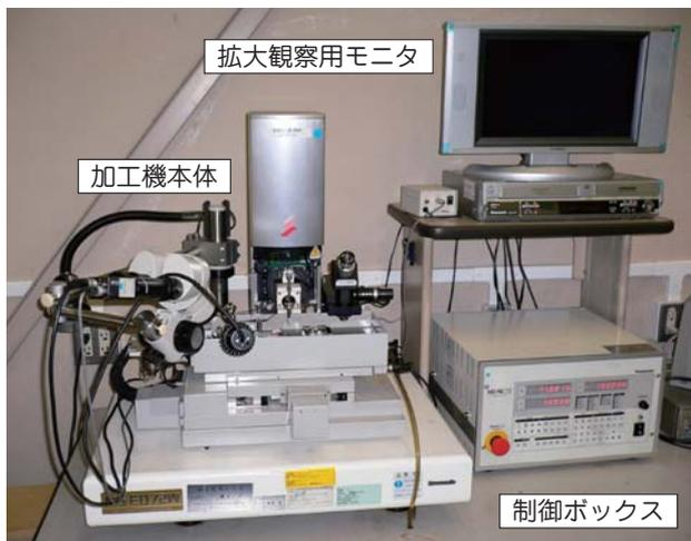
図1 微細放電加工機の外観
