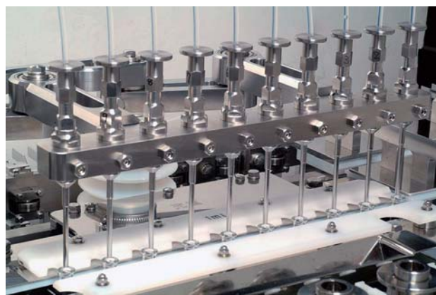
図2 インライン計測による全量計数システム
