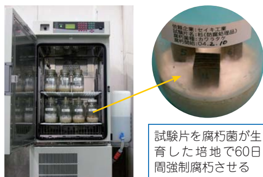
図2 木材耐朽性試験の様子
