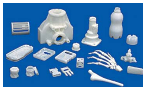
図3 金型レス高速試作モデルの例
