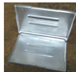
図3 亜鉛合金の超薄肉ダイカスト技術による名刺入れ
