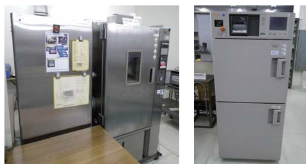
図3 恒温恒湿槽(左)と冷熱衝撃試験機(右)
