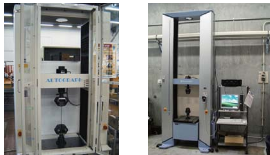
図3 万能試験機 (左：100kN, 右：20kN)
