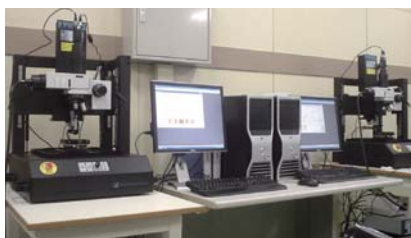
図2 コーティング膜の密着性評価に用いるスクラッチ試験機
