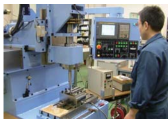
図1 CVDダイヤモンド被覆した金型の超音波研磨加工
