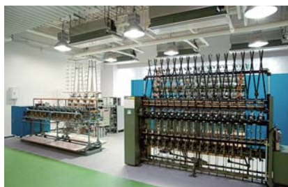
図3 撚糸ゾーン 撚糸機を用いて様々な糸の作製
