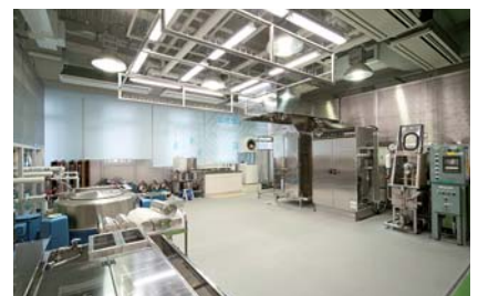
図4 染色ゾーン 糸や布などを染める浸染機器
