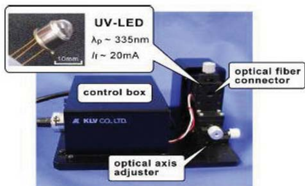
図4 開発中のVOCバイオセンサ試作
