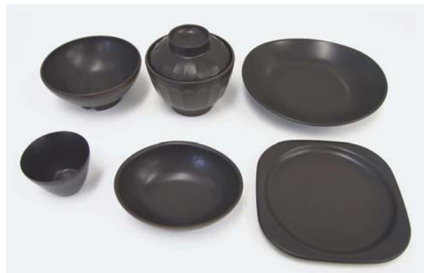
図5 各種形状の金型により成形した100%バイオマス立体成形品
