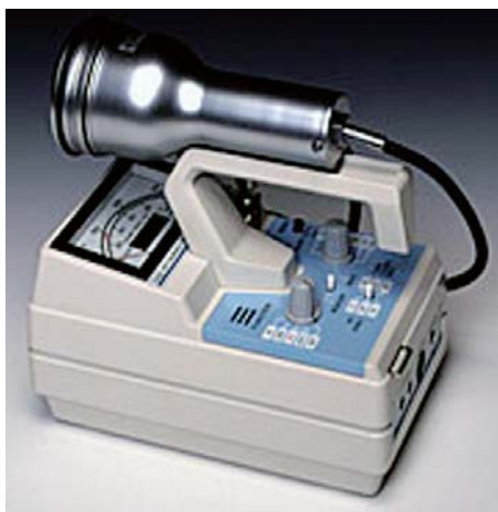
図1 GM計数管を用いた可搬型測定器 (GMサーベイメータ)
