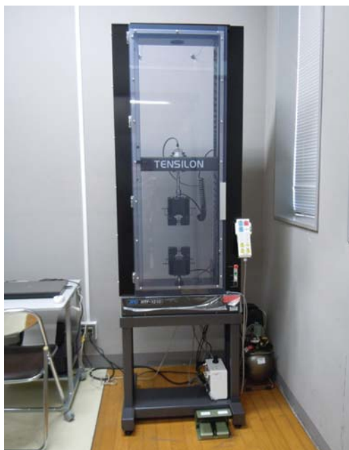
図1 1kN卓上型精密万能試験機 (株式会社エー・アンド・デイ製：RTF-1210)
