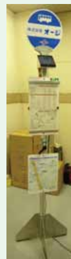
写真3 バス停留所時刻表LED照明装置
