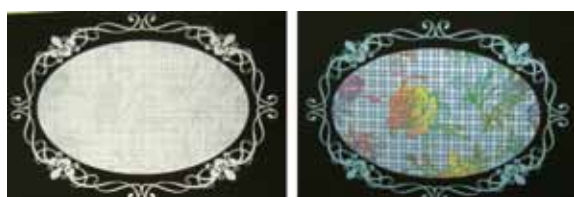
図2 インクジェットプリント例 はじめに白インクでプリントし(左側)、 その上にカラーインクでプリント(右側)
