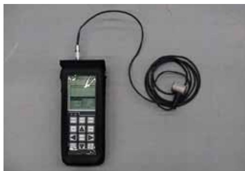
図1 超音波ボルト軸力計
