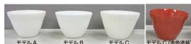
図3 RP造形により試作したぐい呑みモデル
