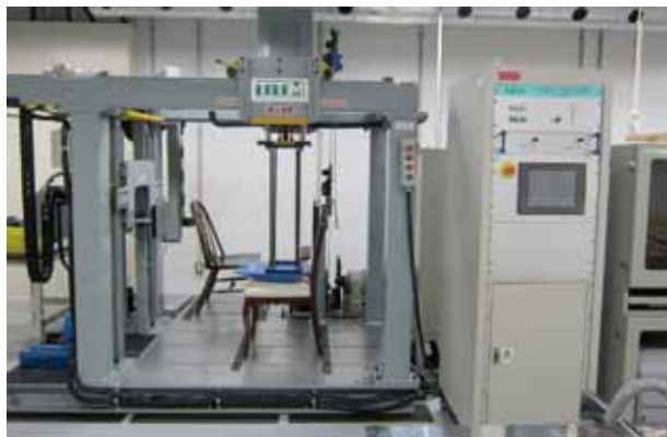
図1 木製家具製品強度試験機
