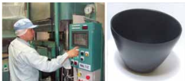
図4 圧縮成形による100%バイオマス成形体の作成
