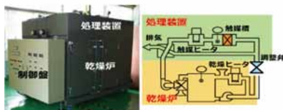
図1 VOC処理装置およびフロー図
