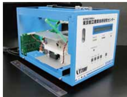
図2 チャージ式PIDセンサ試作器
