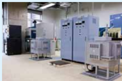
シリコニット電気炉 [常用最大温度:1500℃]
