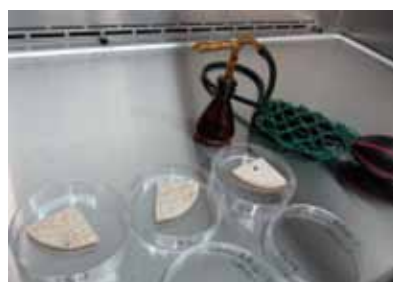
図3 カビ抵抗性試験の様子
