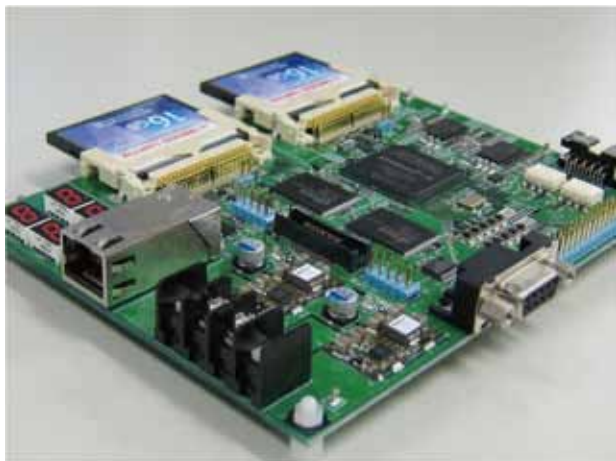
図1 インライン計測のための生産データ記録装置 (KT-FIS) の外観
