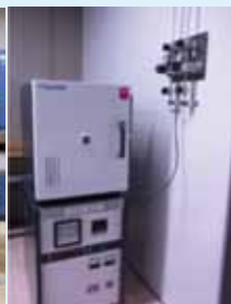
高温雰囲気炉 [最大温度:1700℃]
