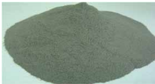
図1 流動性・耐久性に優れた複合系被覆材料DaiSCPの製品パウダー
