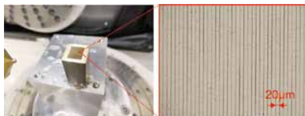
図3 黄銅への引き切り加工例 (V溝90°)
