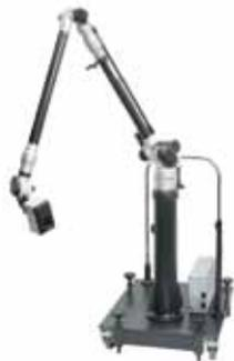
7軸の関節を持つ測定機です。プローブの到達範囲は、直径でおよそ3.5mあり、従来の三次元測定機では測定できなかった大きさの対象物も測定が可能です。また、非接触プローブが取り付けられますので、複雑な三次元自由曲面でも面と
