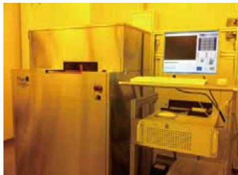
図2 マスクレス露光装置の外観
