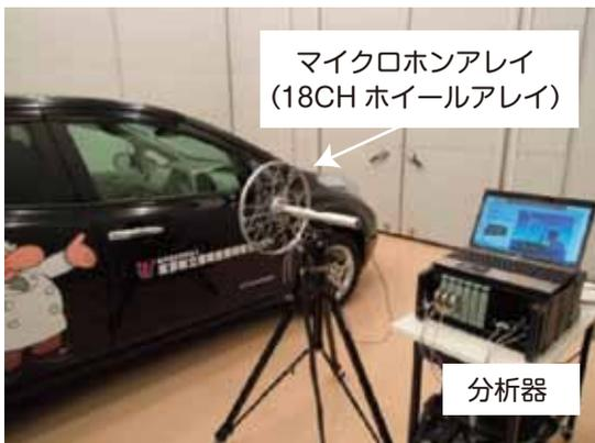
図1 音源探査システム
