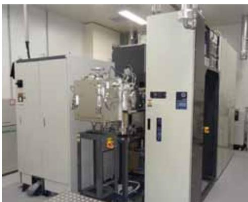
図1 新たに導入されたイオン注入装置
