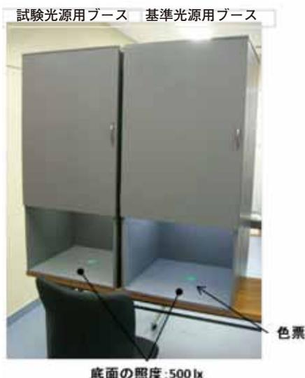
図1 視感評価実験に用いたブースの外観
