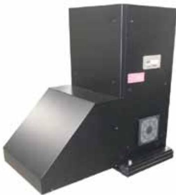
図1 ソーラシミュレータ
