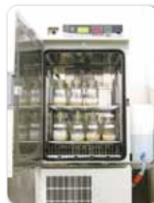
腐朽菌が生育した培地で木材試験片を12週間連続して腐らせる様子
