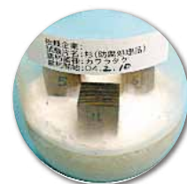
腐朽菌が生育した培地で木材試験片を12週間連続して腐らせる様子
