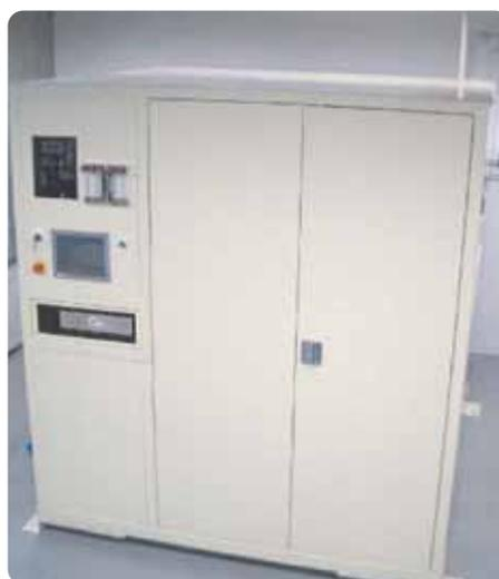
低エネルギー電子線照射装置
