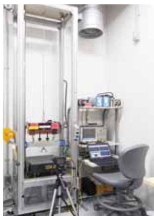
落錘式衝撃特性評価試験機
