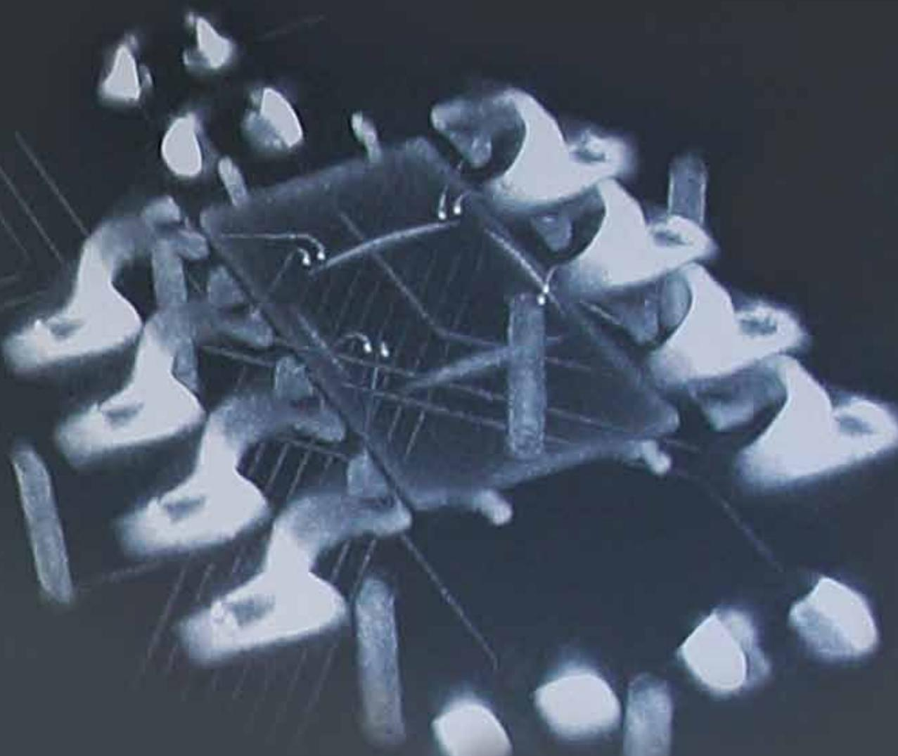
**特集** 都産技研ブランド試験 4 非破壊透視試験
