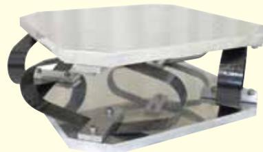
図3 製作中の除振・防振テーブル
