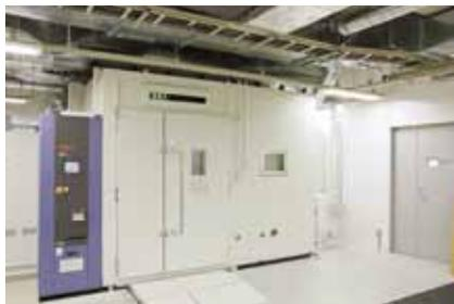
内寸が六畳間ほどあり、屋外設置などの大型の試験品に対応しています。内部に測定機材や人が入ることもできます。性能確認のための動作特性試験などを行う装置です。
