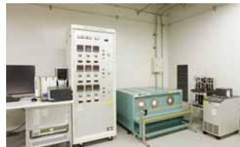
高温域における温度計の評価試験が可能です。お客さまの計測器に対して、計測のトレーサビリティを確保するための依頼試験を受け付けています。
