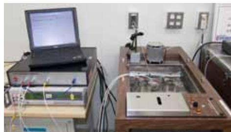
直流抵抗器の自動測定が可能で、抵抗値を10万分の1の桁まで安定して測定することができます。
