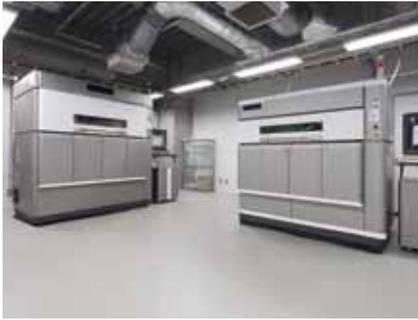
ナイロン粉末タイプの三次元造形機で、大型タイプと精細な表現が可能なタイプを配備。目的に合わせて利用することができます。
