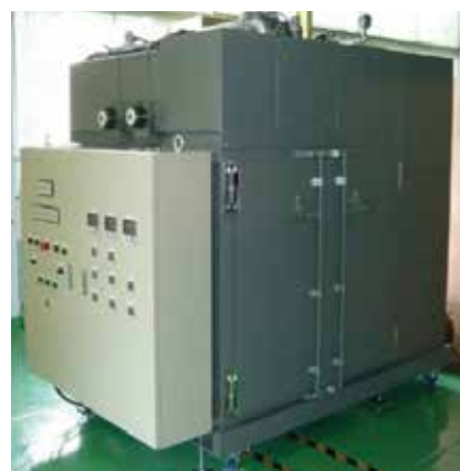
図2 塗装乾燥炉用VOC処理装置 (寸法2150×1400×1950mm)
