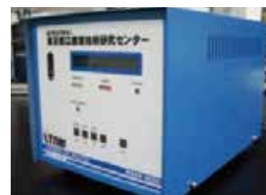
図4 VOC光イオン化センサ (寸法220×200×320mm)
