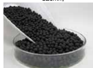
図5 非貴金属系VOC分解触媒 (径4～6mm)
