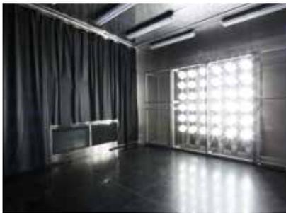
温湿度-30~60℃/10~90%RHのさまざまな条件をつくり出す部屋タイプの試験装置。日射装置との併用により、真夏の日射量1,000W/m<sup>2</sup>を模擬できます。
