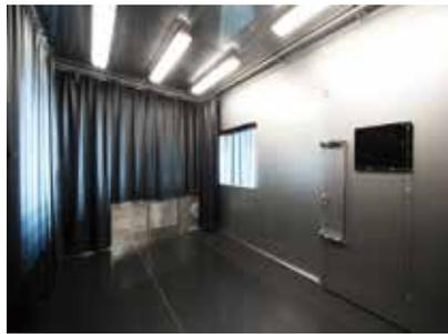
2名の人間が滞在可能。高温多湿環境下での温熱効果を確認できます。主室と同時使用で室内の急激な温度変化も再現できます。
