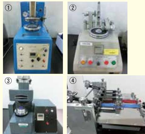
図3 各種摩耗試験機上から、ユニバーサル形、テーバ形、ユニホーム形下段 学振形(平面台)
