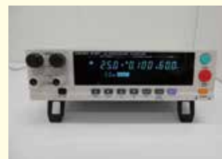
保護導通試験器 メーカー：日置電機 型番：3157
