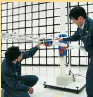
大型機器（φ6mターンテーブル、耐荷重4t/m<sup>2</sup>、電源容量18kVA）の試験も行えます。
