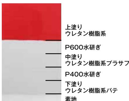
図1 確立した塗装工程例
