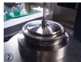
装置の全体像(上)とセンサー部(下) 溶液を下部センサーに設置し(①)、上部センサーで挟みこんで(②)微小振動を加える
