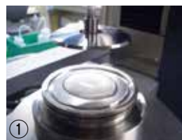
装置の全体像(上)とセンサー部(下) 溶液を下部センサーに設置し(①)、上部センサーで挟みこんで(②)微小振動を加える
