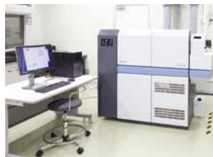
二重収束型ICP質量分析装置 ELEMENT XR(サーモフィッシャーサイエンティフィック社)
