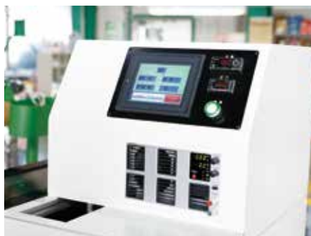
水中ポンプの試験装置。水中ポンプの性能を手軽に試験するために助成金を利用して開発されました。
