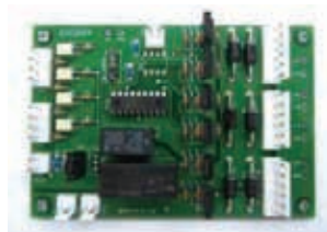
電源/安全制御基板
