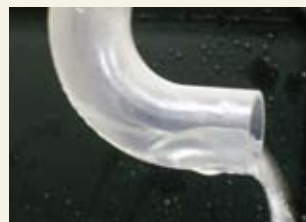
図4 光造形装置により製作した模型を用いた流れの確認例
