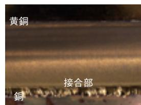
右/黄銅(C2600)のFSWによる突合せ接合部の断面
