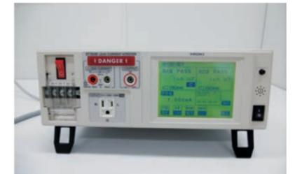
漏れ電流試験器
