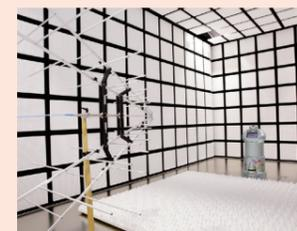
放射イミュニティ試験、静電気放電イミュニティ試験、放射エミッション試験などが可能
