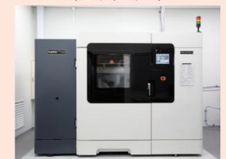
耐久性・耐熱性の高いABS樹脂などを使用して、ロボット筐体など、大型部品を造形可能
