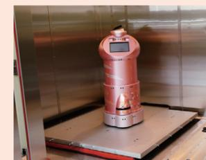
加振台の上にロボットを固定して、振動と同時に温度・湿度を変えて試験可能
