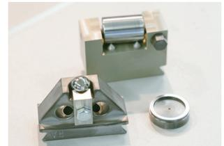
図3 上部試験片の外観と接触形態 (左:点、上:線、右:面)
