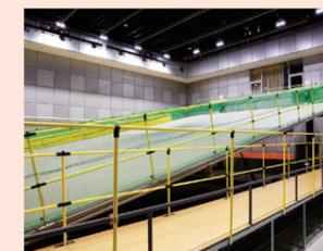
傾斜路でロボットを走行させ、性能や安全性を評価
