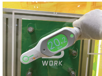
図2 動作中の「TONY」液晶ディスプレイのほか、音や光、振動によって、作業者とコミュニケーションを行う
