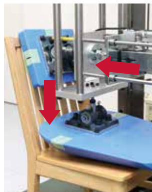
矢印の方向に負荷を加えて試験を行う
