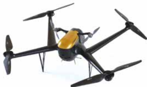
浮上用と推進用のローターを備える高速巡航型マルチコプター
