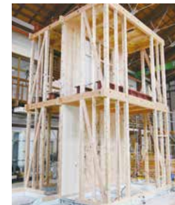
図2 2層振動台実験の様子
