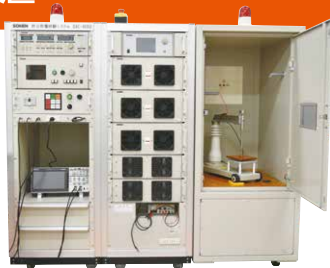
装置外観 左・中央) 測定器・制御部 右) シールドボックス測定部
