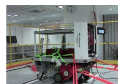
プラザ内の施設での テスト写真 耐久性試験の一つである 「ドラム型走行耐久性試験」 の様子。
