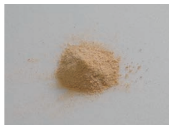
材料写真 (左)原料となる生分解性プラスチック:直径3 mmほどの「ペレット」と呼ばれる粒状形状。 (中)木粉。(右)今回開発した、生分解性プラスチックと木粉を混練した複合材料ペレット。
