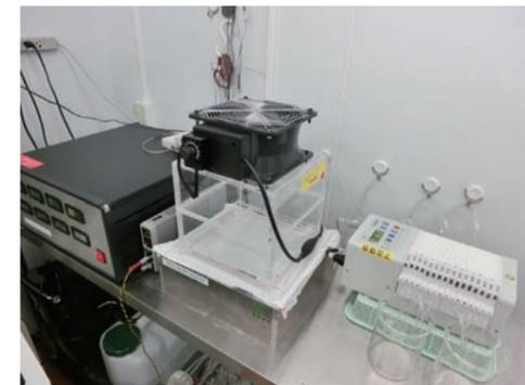
図4 発汗ホットプレート試験機
