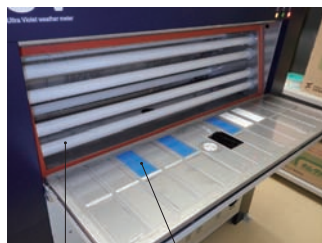
図2 装置内部 紫外線蛍光灯 試験片(15×7cm)
