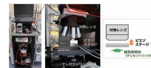
図5 マイクロレンズアレイの集光特性評価装置
