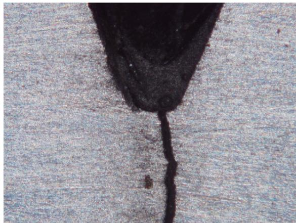
図1 鋼材の疲労き裂
