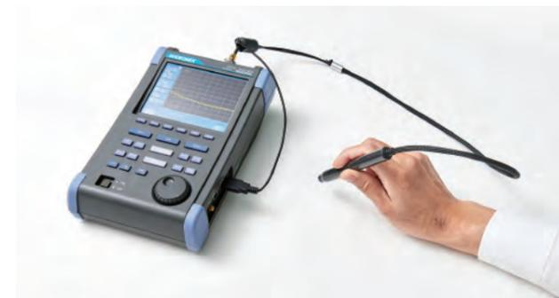
図2 開発した磁界プローブ
