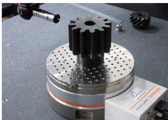
ロータリーテーブルを使用した歯車計測
